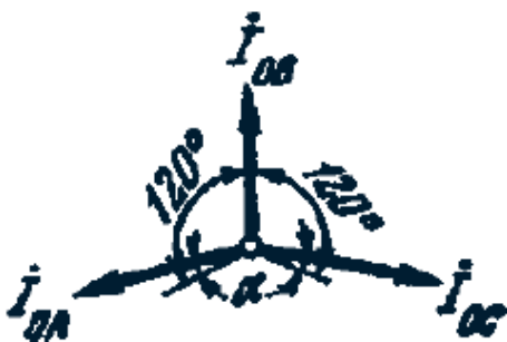
Рис. 19. Токи холостого хода фаз А, В, С.
