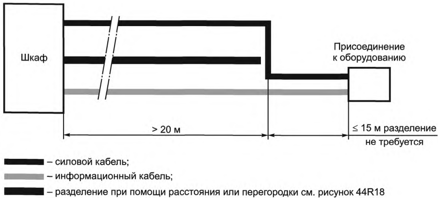
Рисунок 44.R17В — Разделение силовых и информационных кабелей при длинах кабельной трассы > 35 \text{ м}
