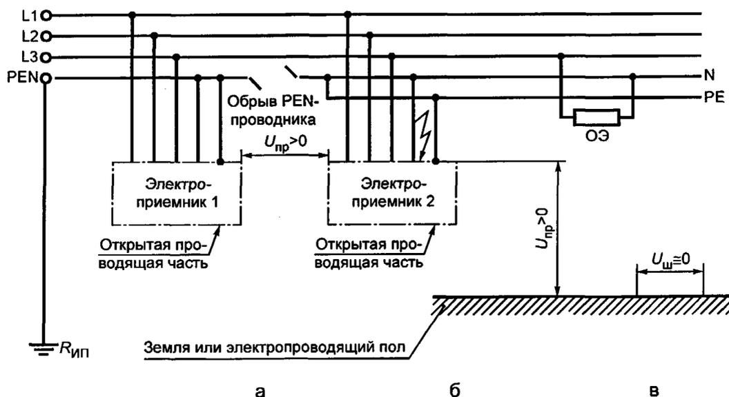
Рисунок В.7 — Сеть TN-C-S с обрывом PEN-проводника
