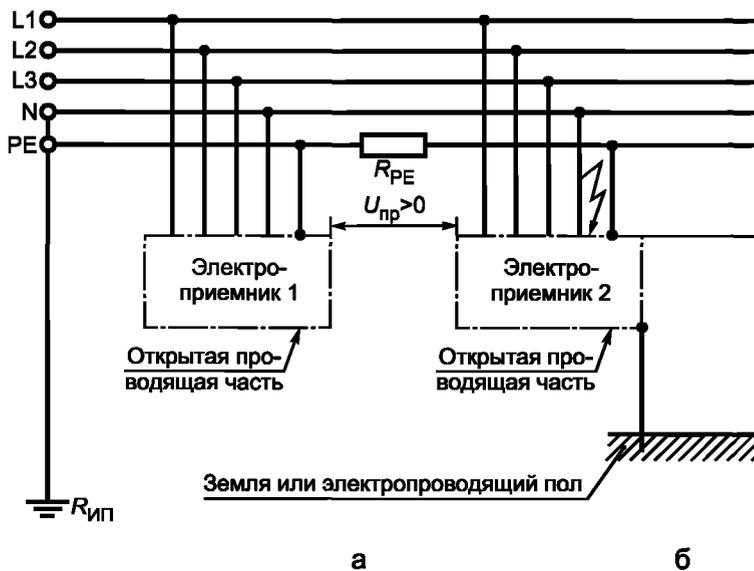
Рисунок В.6 — Сеть TN-S с однофазным замыканием на корпус
